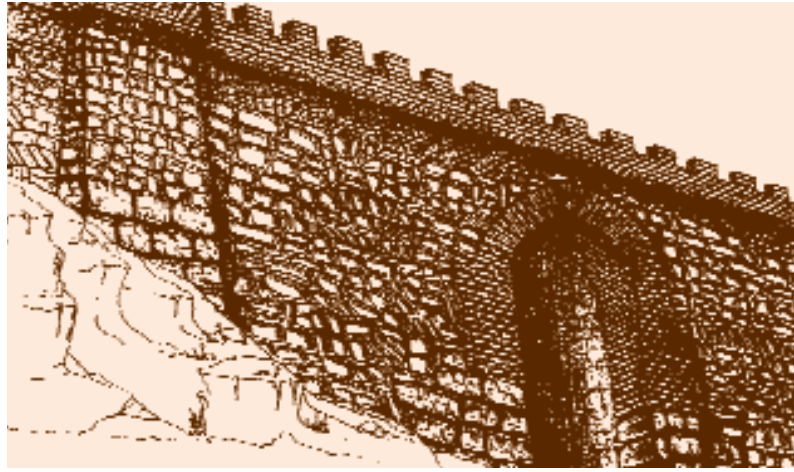
Əlincəqala. Qərb qapısının bərpa layihəsi.
