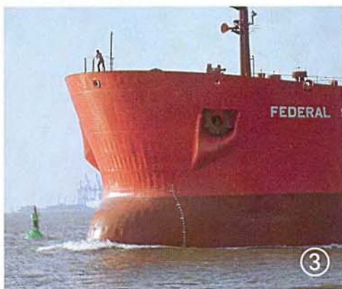
На этих шести фотографиях показаны основные типы конструкции носовой и кормовой части морских судов. Такие корабли строились на протяжении последних ста лет. 1. пароход с острым вертикальным форштевнем 2. округлый выступающий нос 3. бульбообразный нос (известно несколько его вариантов) 4. эллиптическая корма 5. крейсерская корма 6. транцевая корма
