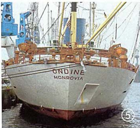
На этих шести фотографиях показаны основные типы конструкции носовой и кормовой части морских судов. Такие корабли строились на протяжении последних ста лет. 1. пароход с острым вертикальным форштевнем 2. округлый выступающий нос 3. бульбообразный нос (известно несколько его вариантов) 4. эллиптическая корма 5. крейсерская корма 6. транцевая корма
