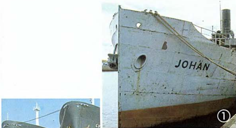
На этих шести фотографиях показаны основные типы конструкции носовой и кормовой части морских судов. Такие корабли строились на протяжении последних ста лет. 1. пароход с острым вертикальным форштевнем 2. округлый выступающий нос 3. бульбообразный нос (известно несколько его вариантов) 4. эллиптическая корма 5. крейсерская корма 6. транцевая корма
