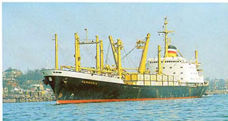
Современное быстроходное грузовое судно (контейнеровоз). На его палубе установлен специальный такелаж для перемещения тяжелых грузов и ряд контейнеров со штучным товаром.
