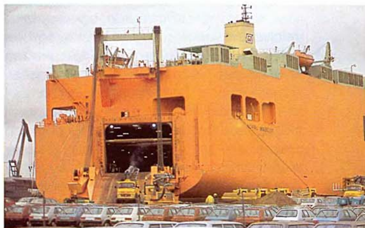
Вверху: ролкер и контейнерное судно. Внизу: судно для транспортировки автомобилей. Через грузовые ворота машины съезжают на берег.
