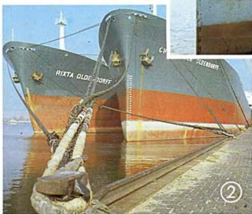
На этих шести фотографиях показаны основные типы конструкции носовой и кормовой части морских судов. Такие корабли строились на протяжении последних ста лет. 1. пароход с острым вертикальным форштевнем 2. округлый выступающий нос 3. бульбообразный нос (известно несколько его вариантов) 4. эллиптическая корма 5. крейсерская корма 6. транцевая корма
