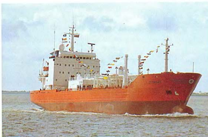
Танкер для перевозки сжиженных газов с холодильными установками на палубе.
