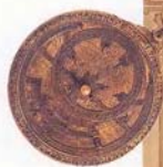
Арабские ученые изобрели астролábio — универсальный прибор для астрономических наблюдений и измерений горизонтальных углов при землемерных работах
