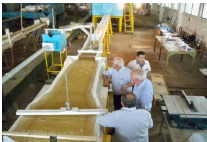
Qəbələ rayonunda tikintisi nəzərdə tutulan Yengicə su anbarının suötürücü və suburaxıcı qurğusunun qurulmuş modelində sınağın aparılması
